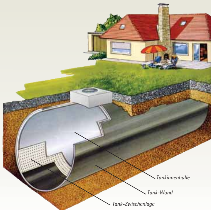
Flexible Tankraumauskleidung - anpassbar, rissüberbrückend, dauerhaft dicht.
